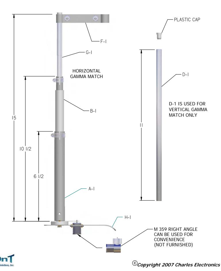
Assemble Gamma Matches per diagram.
